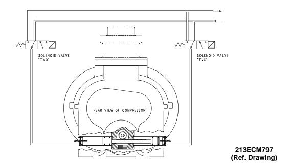
FIGURE 4-8 - TURN VALVE - ELECTRA-SAVER ONLY
