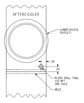
FIGURE 5-3 - COOLER DRAIN DETAIL
