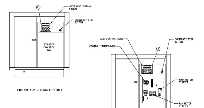
FIGURE 1–3 – PACKAGE – CONTROLLER & STARTERS
