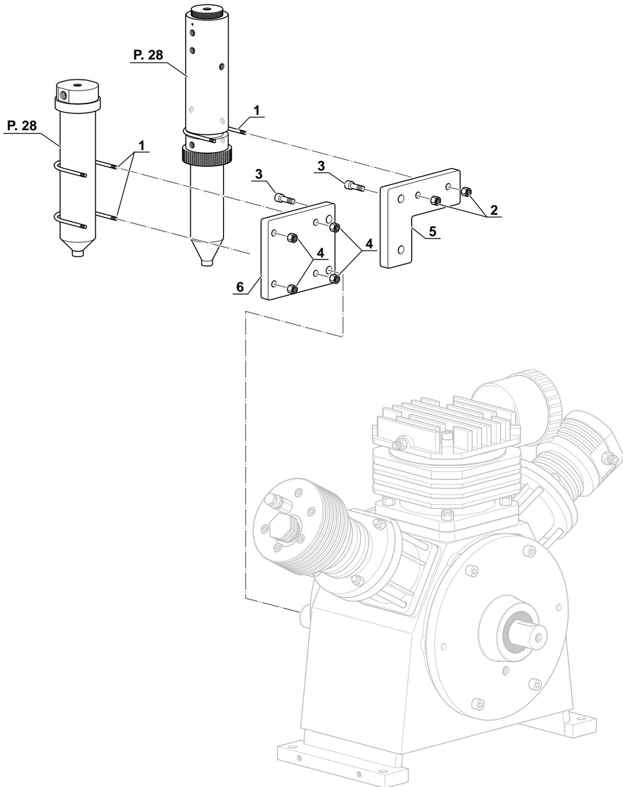
**SEPARATORE DI CONDENZA - CONDENSATE SEPARATOR**
