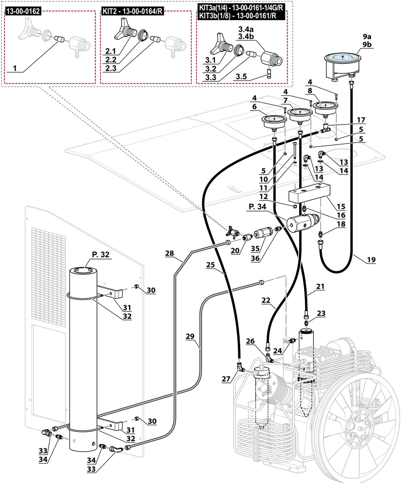
**CIRCUITO DI FILTRAZIONE - FILTERING CIRCUIT**
