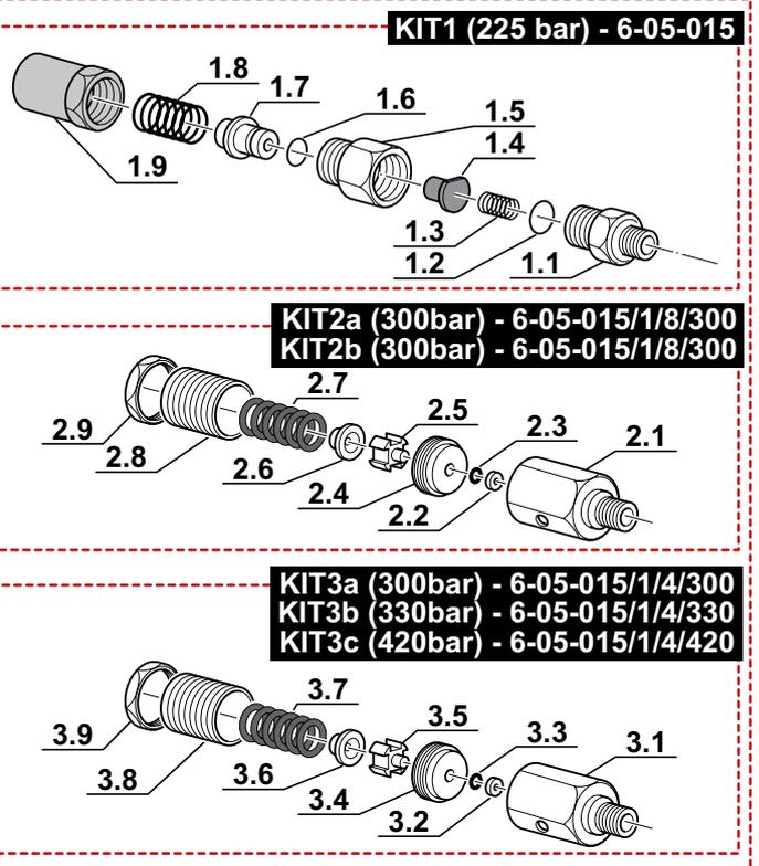
**VALVOLA MANTENIMENTO PRESSIONE - PRESSURE MAINTENANCE VALVE**
