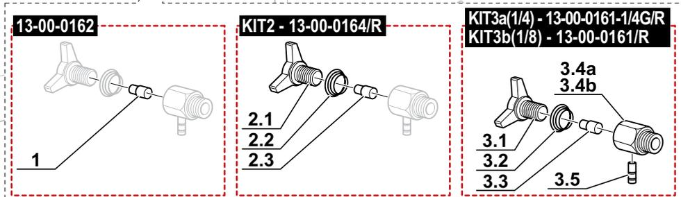
**CIRCUITO DI FILTRAZIONE - FILTERING CIRCUIT**
